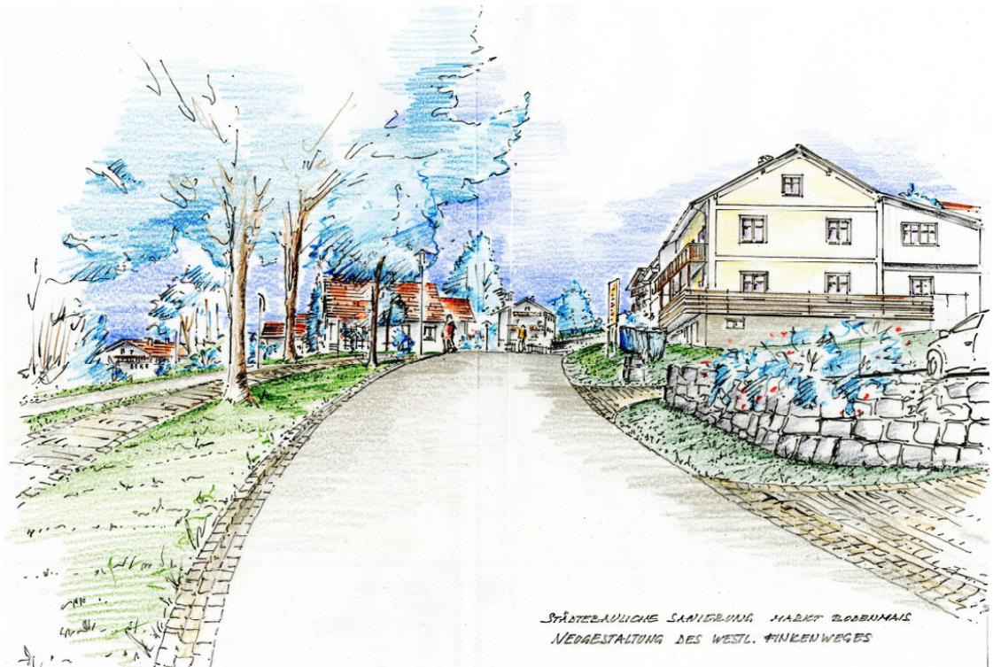
Durch Reduzierung der Fahrbreite, Absetzen des Gehweges sowie Querneigungsdrehung wird der Finkenweg besser in den Kurpark eingebunden
